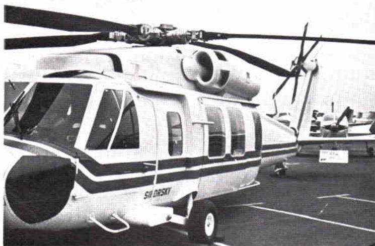
Rotorblad av glas och kolfiberarmerad plast har man nu tagit fram.
